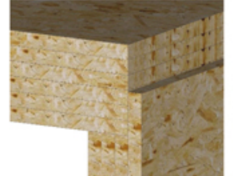
Decke auf Außenwand
